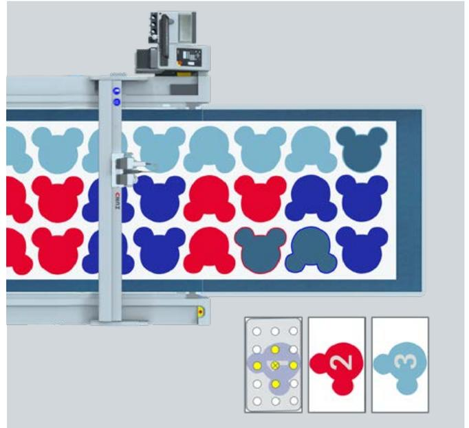
En este ejemplo se activan cinco ventosas para extraer la pieza. En este caso, el cabezal de aspiración se orienta automáticamente hacia la posición ideal de extracción.
