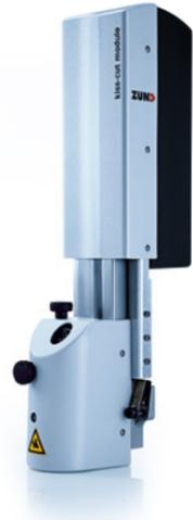
Präzises Kiss-Cutting mit exakt einstellbarem, elektronisch gesteuertem Anpressdruck.
