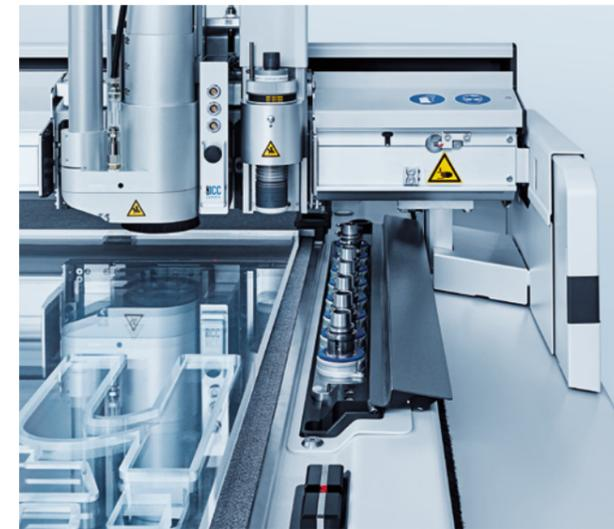
Effizientes System zur Automatisierung des Fräserwechsels von der Auswahl des richtigen Fräasers bis zum Einspannen, Initialisieren und Reinigen des Fräasers.
