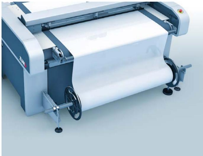
Im Gegensatz zur Abrolleinheit Universal eignet sich die Abrolleinheit mit Kernaufnahme perfekt für weiche und flexible Materialien oder Textilien. Die Materialrolle wird auf einer Welle eingespannt und auf der Abrolleinheit platziert. So werden Walkbewegungen während der Zuführung vermieden.
