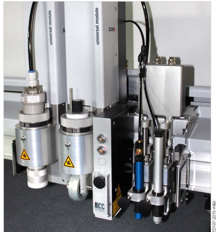
Voll bestückter Modulträger mit 2 UM, ICC Kamera und MAM-D.
