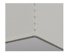
Das PTT1 ist zur Aufnahme von Perforiermessern konzipiert. Mit den Perforiermessern können Perforierlinien effizienter hergestellt werden als mit einem oszillierenden Werkzeug. Perforierungen unterstützen unter anderem das Falten/Biegen von Rilllinien. So können diese präziser ausgeführt werden. Neben den klassischen Materialien Wellkarton, Vollkarton und PP (Polypropylen) können auch Folien perforiert werden.
