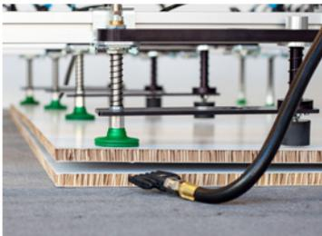
Zusätzliche Separiereinheit (hinten) zur zuverlässigen Vereinzelung von Plattenmaterial, bestehend aus vier Balgsaugereinheiten und zwei Separierdüsen:
