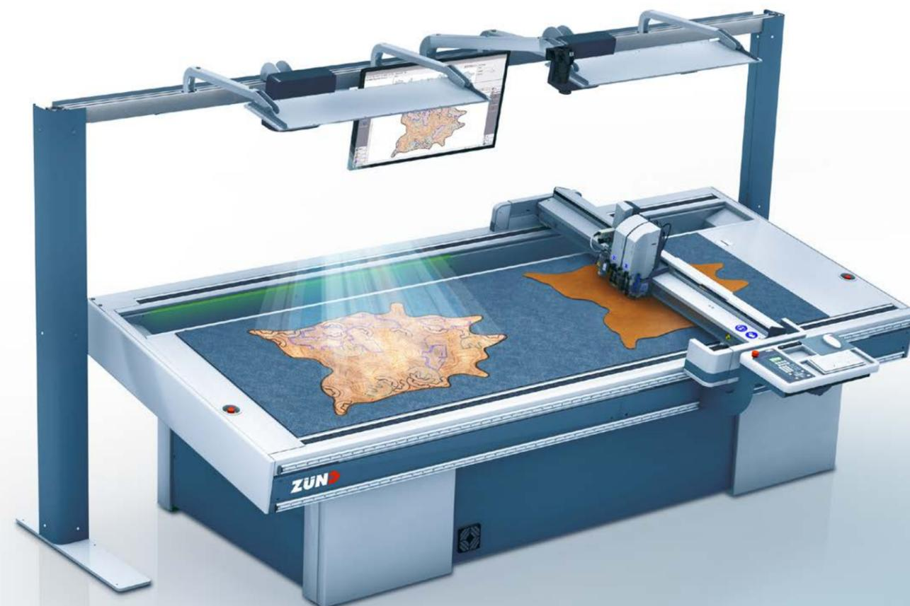
Incremente su productividad en la producción de zapatos. Procese piel, material para suelas, para relleno y también para plantillas de forma precisa y eficaz: Con la herramienta de corte oscilante y la cuchilla Zünd adecuada puede cortar, por ejemplo, piel a una velocidad de hasta un metro por segundo. El Punch Module punzona mediante dos herramientas independientes entre sí hasta ocho agujeros por segundo.
