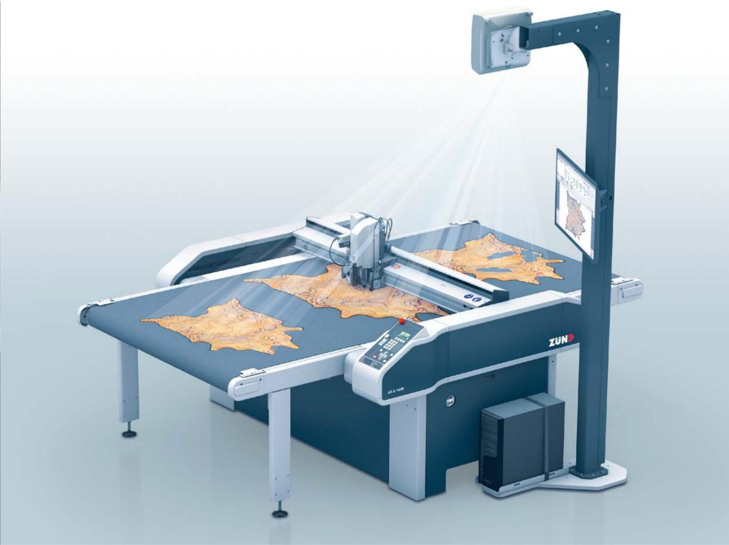
Los cortadores Zünd se utilizan tanto para la fabricación de prototipos como para la producción en serie. Para cada entorno de producción Zünd ofrece la solución adecuada. Esto garantiza 17 tamaños de cortador, una amplia gama de herramientas y sistemas de manipulación de diseño inteligente para diferentes materiales. Según sus necesidades de producción puede configurar su sistema de cortador de forma individual y a medida. Invierta en la funcionalidad que necesita.
