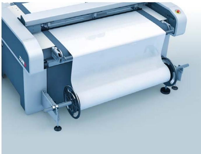
En comparación con la desbobinadora universal, la desbobinadora con eje es la indicada para materiales textiles suaves y productos flexibles. El eje se coloca dentro de la bobina y se coloca sobre el soporte de la desbobinadora. Así, se evita la flexión durante el avance.
