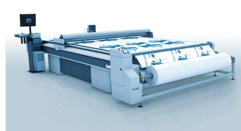
Mediante el tensor de doble rodillo pueden alimentarse rollos con un peso por debajo de 40 kg; dicho tensor sirve en caso necesario como desbobinadora pasiva.
