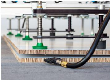
Unidad adicional de separación (atrás) para separar de manera eficaz el material en forma de planchas, compuesta por cuatro unidades de aspiración en forma de fuelle y dos boquillas de separación:
