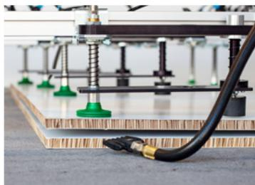
Separatore supplementare (posteriore) per la singolarizzazione affidabile di materiale in lamine, composto da quattro ventose a soffietto e due separatori a ugelli:
