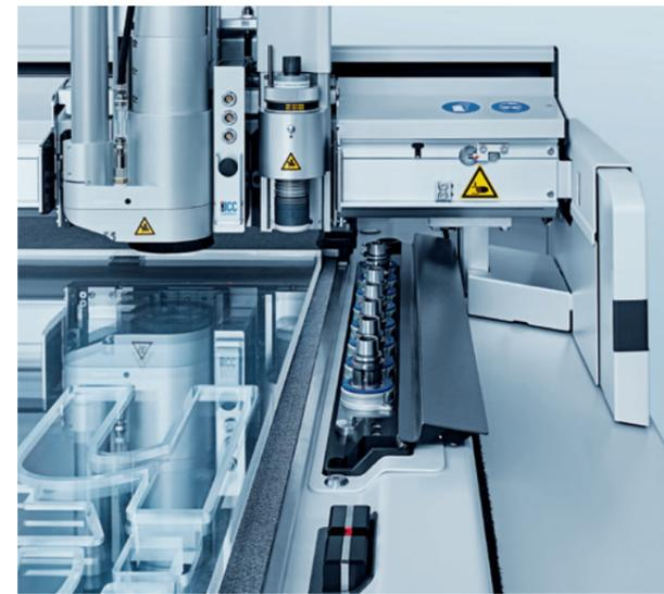
Efficiente sistema di automazione della sostituzione della fresa dalla scelta della fresa corretta al montaggio, all'inizializzazione e alla pulizia della fresa.
