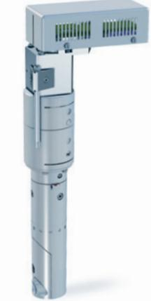
Utensile per tessuti tecnici e materiali tessili. La lama rotante motorizzata consente una velocità di lavorazione molto elevata.
