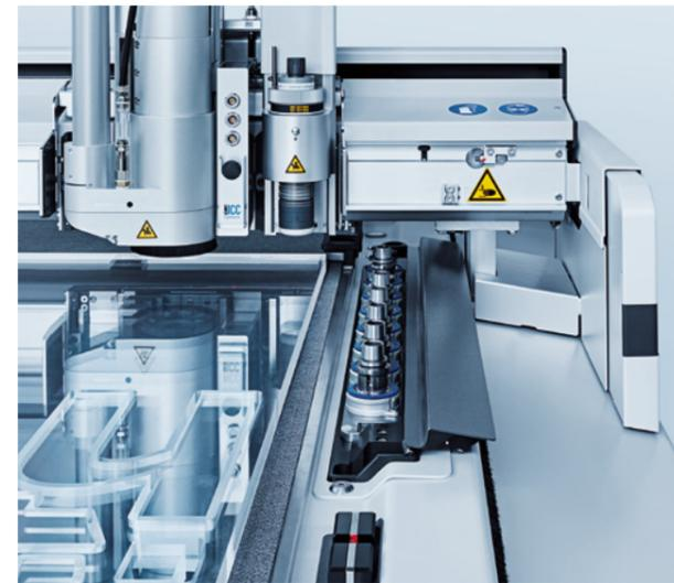
Efficiente sistema di automazione della sostituzione della fresa dalla scelta della fresa corretta al montaggio, all'inizializzazione e alla pulizia della fresa.
